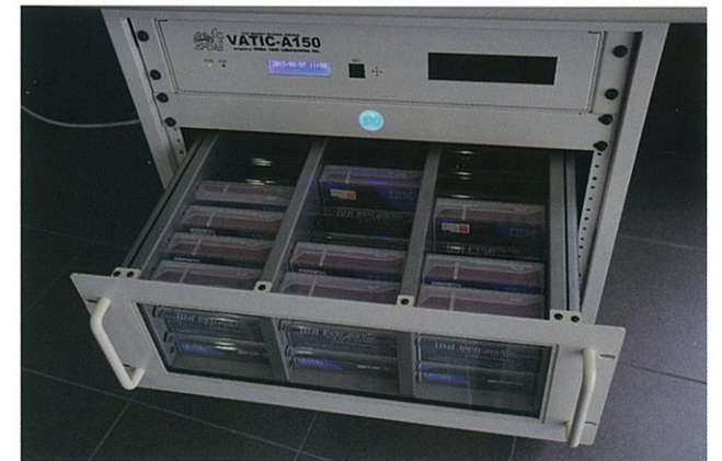
ストッカー2段に収納できるLTOテープは60本。しかも、ストッカーは増設可能。LTOテープは第10世代までのロードマップが明確にされており、そのパフォーマンスは容量が非圧縮時48TB、圧縮時120TB、転送速度が非圧縮時1100MB/秒、圧縮時2750MB/秒
